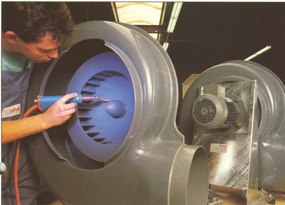
Afmontage van Vinitex ventilator.
